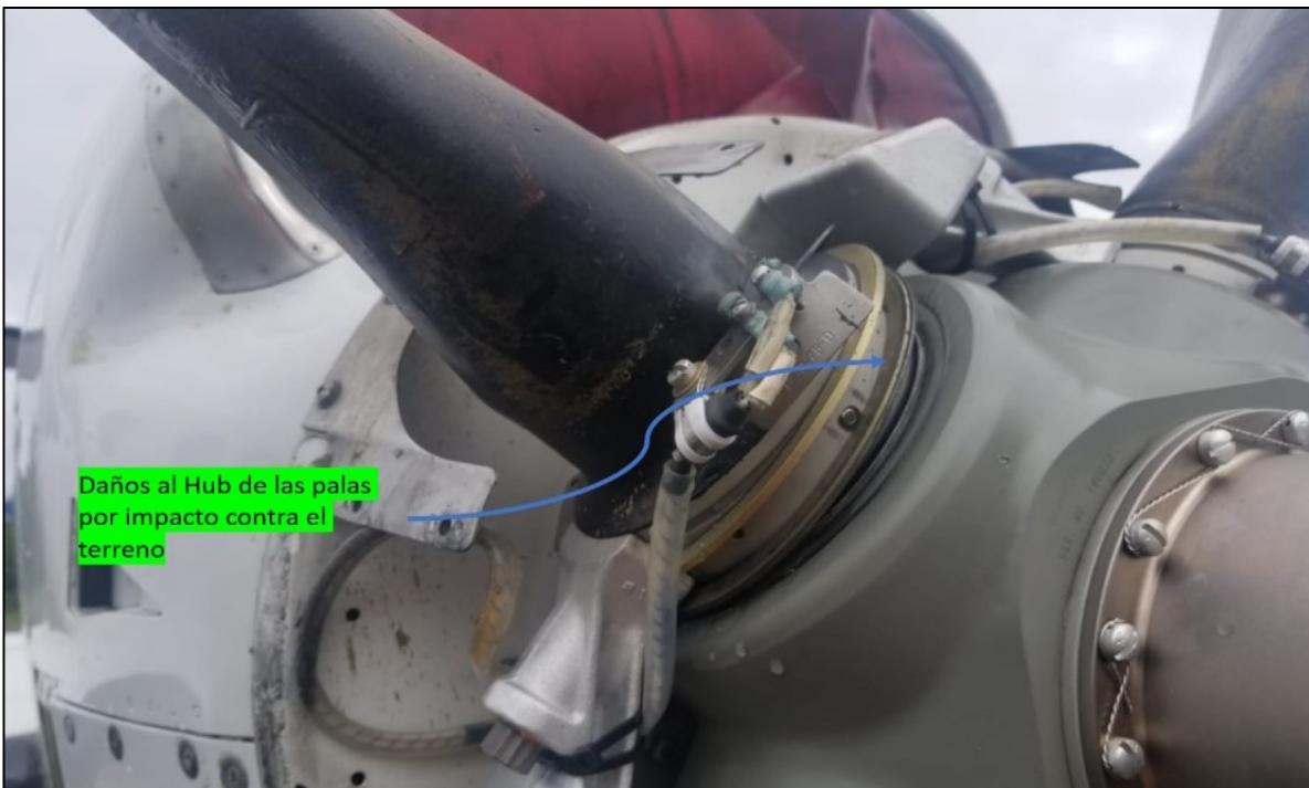
Fotografía No. 5: Estado final de las palas de hélice HK4394
