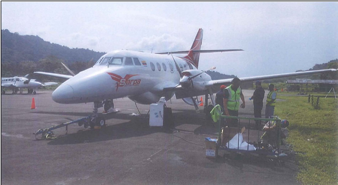
Fotografía No. 13: Instalación equipo para prueba hidráulica HK4394
