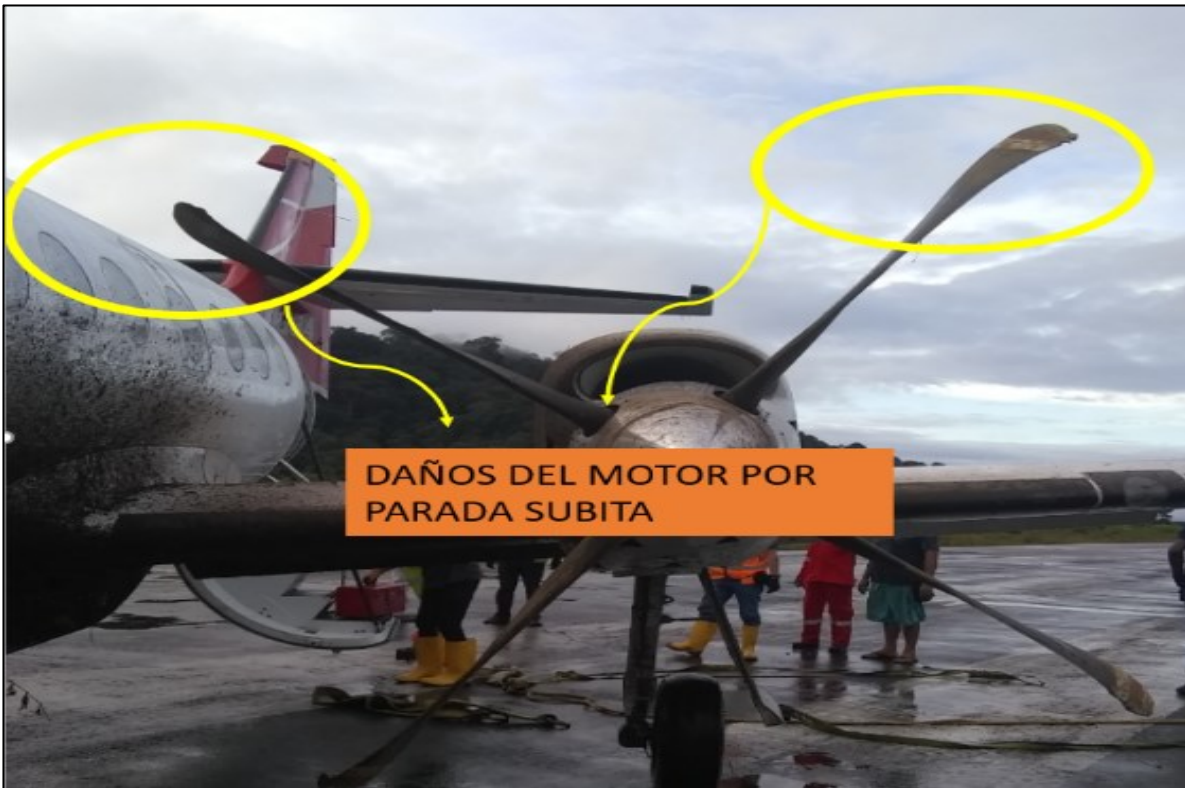
Fotografía No. 4: Estado final de las palas de hélice HK4394
